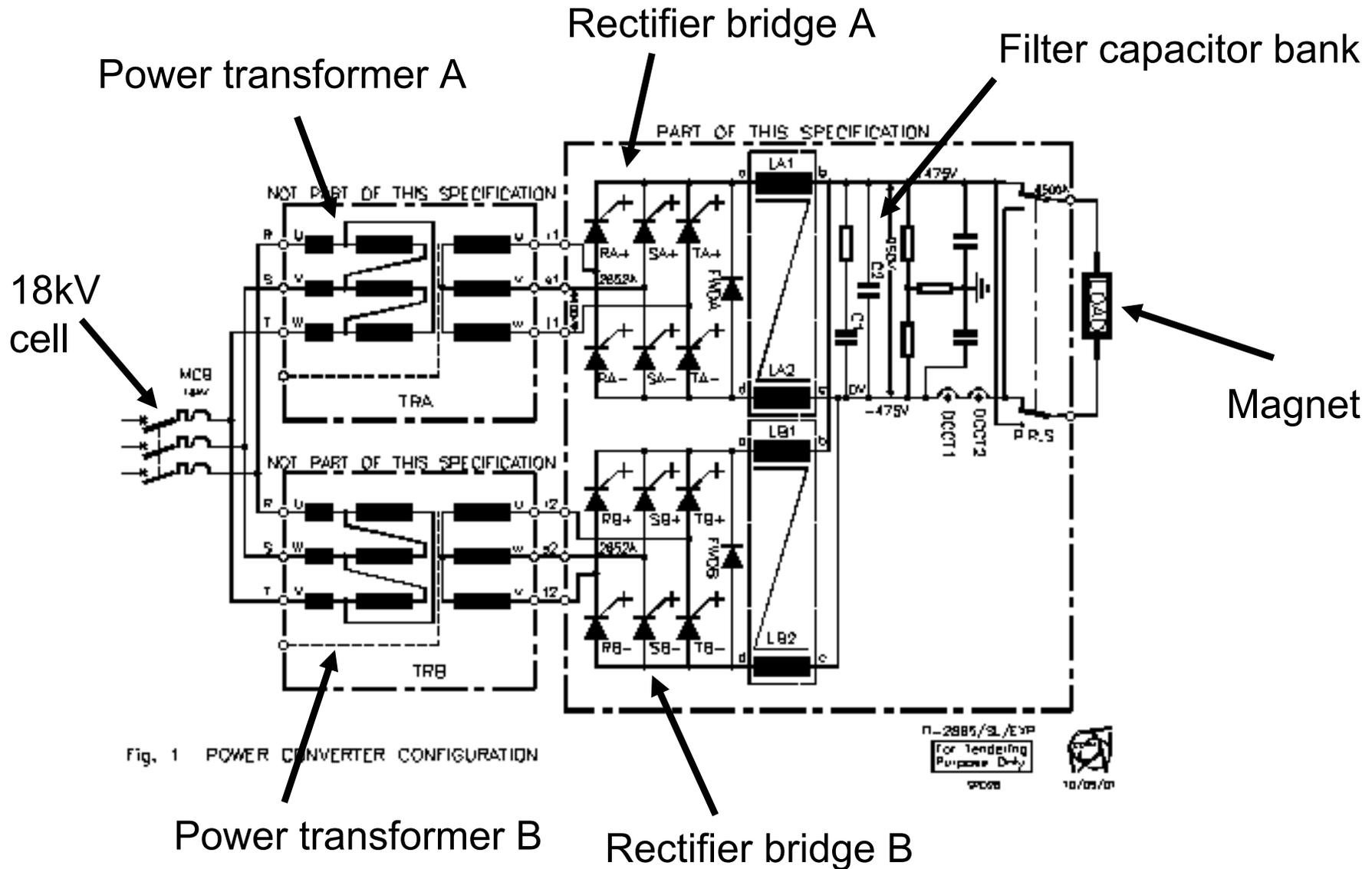
Fig. 1 POWER CONVERTER CONFIGURATION
